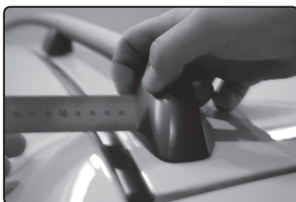
Zadní patku umístěte 10mm od vnitřní hrany podélné střešní lišty vozu.
