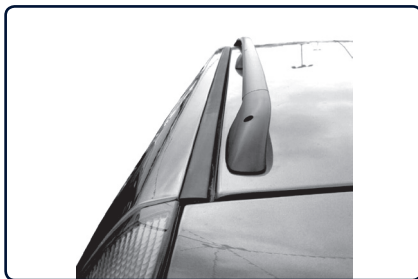
Podélný střešní nosič se instaluje na vnitřní stranu od podélné střešní lišty vozu.
