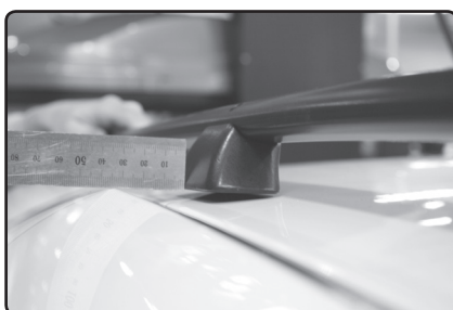
Střední patku umístěte 10mm od vnitřní hrany podélné střešní lišty vozu.
